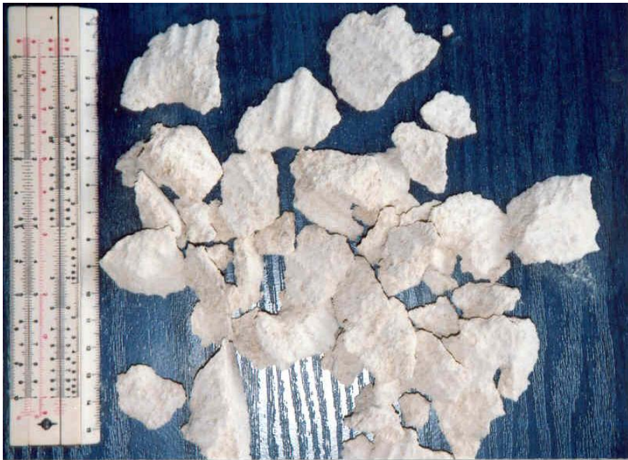
Rys. 4.3b. Charakterystyczne kształty i wymiary elementów wióra (wapień pińczowski, h = 14\text{mm} )
