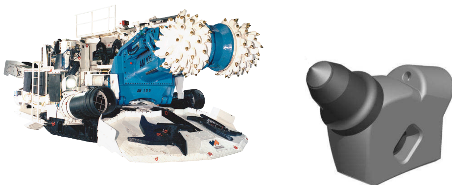
Rys. 1. KOMBAYN chodnikowy wyposażony w głowicę urabiającą zbrojoną stycznymi nożami obrotowymi.
